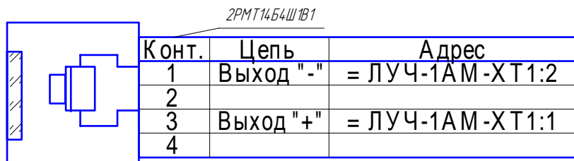
Рис.8. Выходные электрические цепи фотодатчика ФД-02 (ФД-02Т)
