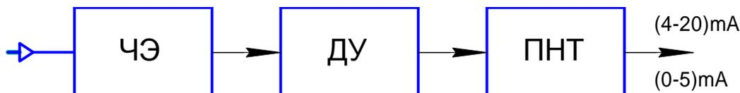
Рис.1 Структурная схема датчика
